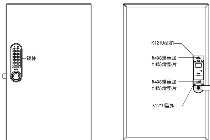
图 5.5 在门板上安装锁体
