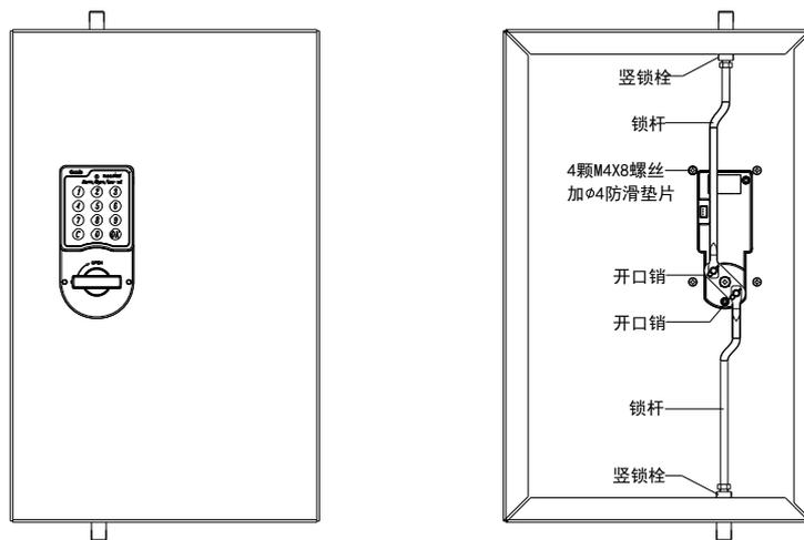
图 5.2—**在门板上安装锁体及拉杆**
