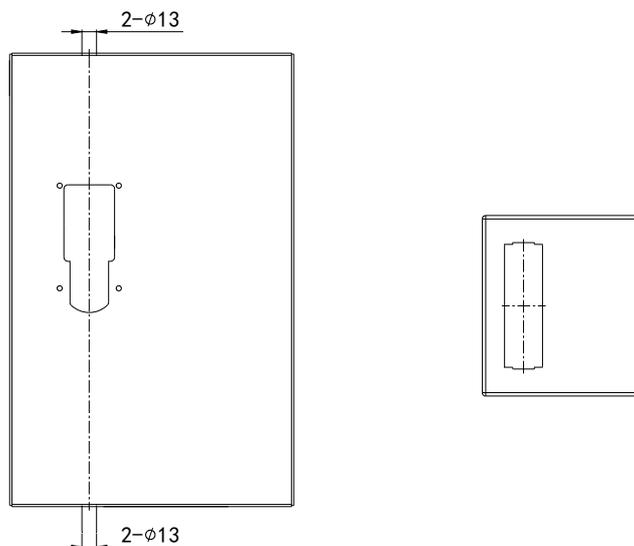
图 5.1—**在门板上冲锁体安装孔**
